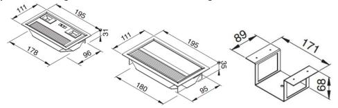
Die Apparatehalterung wird direkt am Kabeldurchlass befestigt (Schrauben bauseits). Unter der Apparatehalterung muss mind. 10mm Freiraum sein.
