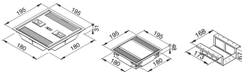
Die Apparatehalterung wird direkt am Kabeldurchlass befestigt (Schrauben bauseits). Unter der Apparatehalterung muss mind. 10mm Freiraum sein.
