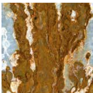
Zingage à chaud (20µm) au bout de 6 semaines
